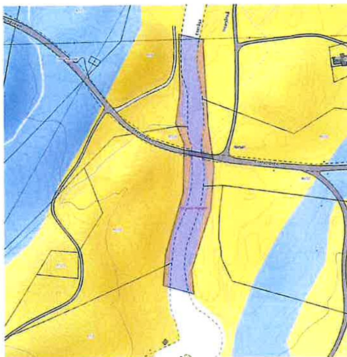
Figur 3 Elvekråninger i markert område må erosjonssikres.
